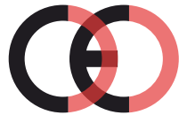
Falsche CE-Kennzeichnung (zu dicht)
